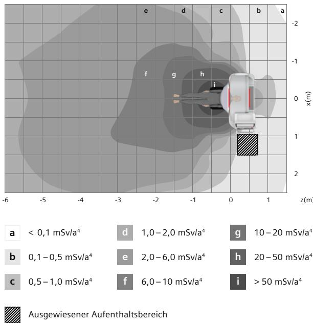
Eine große Herausforderung beim mobilen Scannen ist die Sicherheit des Personals und benachbarter Patient\*innen hinsichtlich der Streustrahlung. Aus diesem Grund verfügt SOMATOM On.site über ein ganzheitliches Strahlenschutzkonzept, das in die teleskopische Gantry integriert ist.
