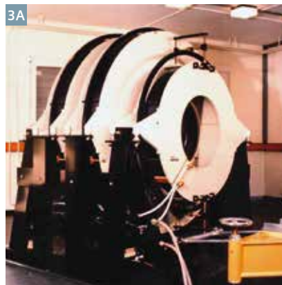
3 (3A) Hava soğutmalı 0.1 Tesla mıknatısı, 1978. (3B) Faraday kafesli 0.1T mıknatısı, 1979.
