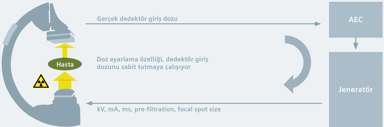
Şekil 3: Gelişmiş radyasyon kontrolü (AEC) ve sabit dedektör giriş dozunda doz ayarlama prensibi. AEC, dedektör giriş dozunu ihtiyaç duyulan düzeyde tutmak ve mümkün olan en yüksek görüntü kalitesini elde etmek üzere seçilen organ programı kapsamında gerçek dedektör giriş dozunu analiz ediyor ve beş farklı parametreyi otomatik olarak ayarlıyor.
