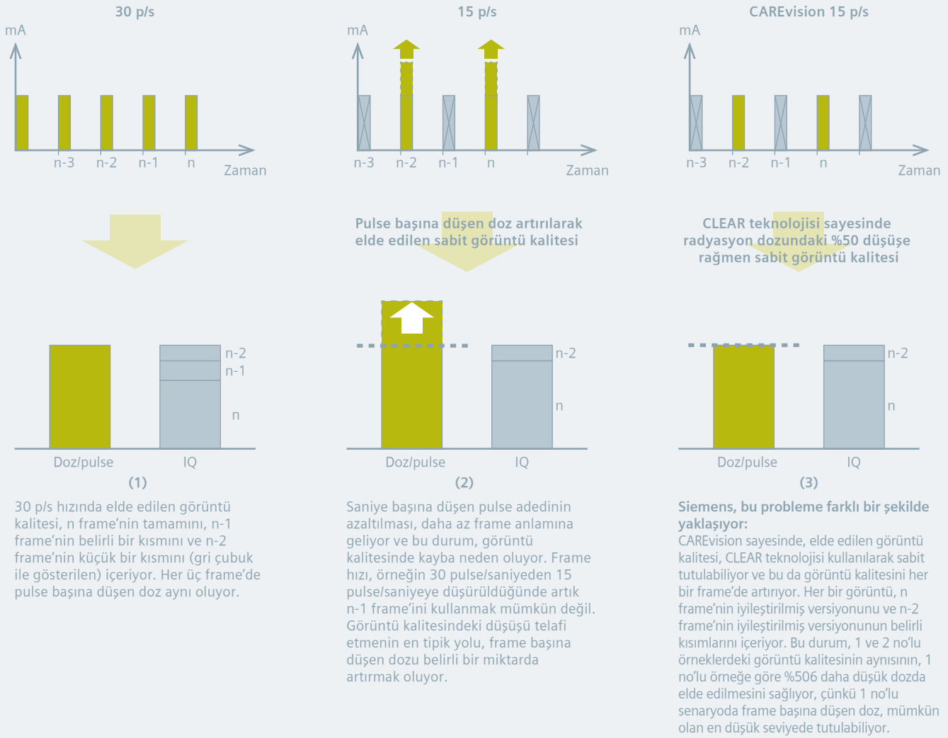
Şekil 14: Elde edilen görüntü kalitesi, insan yapımı görüntüleme sisteminin, kısmi olarak her zaman geçmiş çekimlere ait frame'leri dikkate aldığı gerçeğini gösteriyor. Bu durum, mevcut frame (n) ile geçmiş frame'ler (n-1, n-2 vb.) arasındaki geçici ilişkiyi gösteren üst kısımda ortaya koyuluyor. CLEAR teknolojiyi CAREvision fonksiyonu, düşük pulse hızında dahi, pulse başına düşen dozu artırmaksızın görüntü kalitesini sabit tutuyor.
