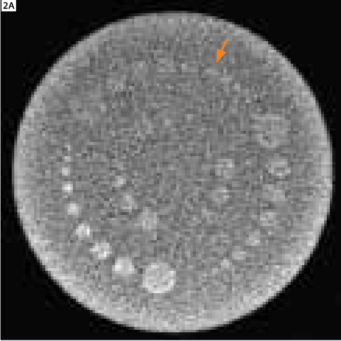
2A SOMATOM® Definition AS+ sisteminde (11,0 mGy'lik CTDIvol dozunda) standart vücut taraması protokolü ile taranmış ve 10 mm'lik kesit genişliği ile yeniden yapılandırılmış CATPHAN® fantomunun LC modülü. Radyologların %50'si, veri setlerinin %50'sinden fazlasında 5 mm'lik 3 HU'luk modülü (turuncu ok) tespit edebildi. Siemens bu nedenle, SOMATOM Definition AS+ sistemi için LCD değerini, 11,0 mGy dozunda 5 mm 3 HU olarak belirliyor.
