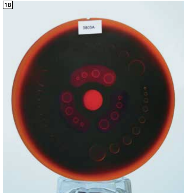
1B 200 mm çapındaki CATPHAN® fantomun düşük kontrast modülü; düşük kontrast tespit edilebilirliği test fantomuna bir örnek: çapları 2-15 mm, kontrast seviyeleri 3-10 HU arasında değişen periyodik modüller.
