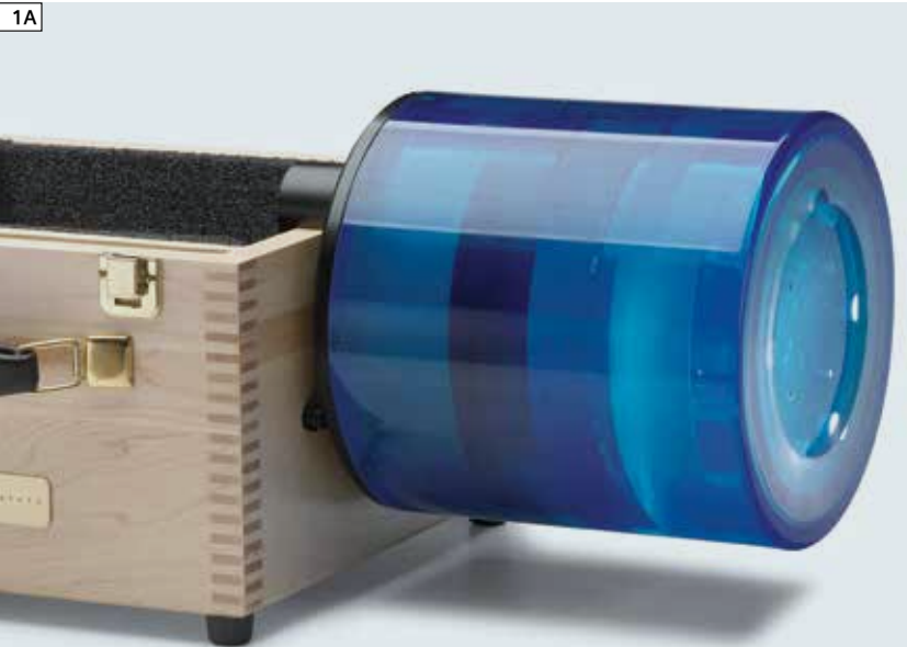
1A Düşük kontrast tespit edilebilirliğini belirlemek için CATPHAN® fantomu (The Phantom Laboratory, New York) veya nispeten düşük kontrastlı test modüllü benzer bir fantom kullanılabilir. (Fotoğraflar için New York'taki The Phantom Laboratory'ye teşekkür ederiz.)
