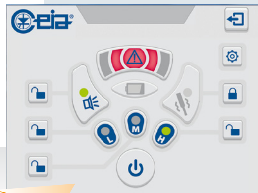
Indication visuelle proportionnelle à l'intensité du signal [Faible, Moyenne, Haute]
