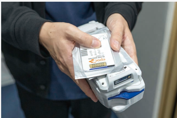
ハンディタイプの血液ガス分析装置エポック(シーメンスヘルスケア・ダイアグノスティクス株式会社製)と専用の測定カード
