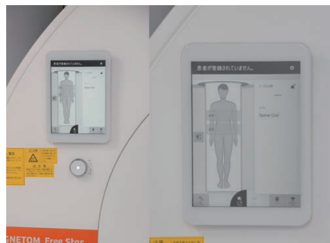
図6 ガントリー前面のタッチパネルモニターによりワンタッチで検査部位を設定可能
