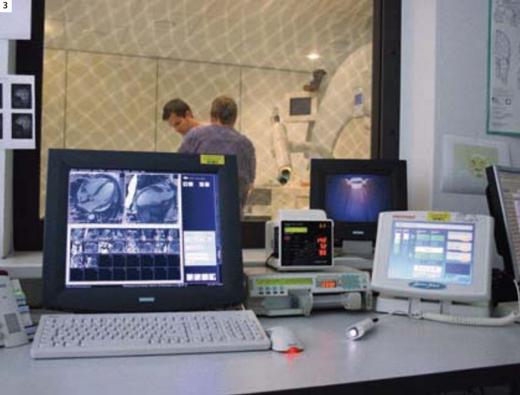
3 CCTVスクリーン、アデノシン灌流ポンプ、インジェクタ・コントロールユニット、BP/SpO 2 モニタリング装置をMR撮影ワークスペースの隣に配置して、最適なワークフローと患者モニタリングを確実に実現している。
