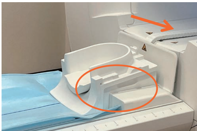
図4 頭頸部コイルのチルト機構(楕円)とガントリ埋込み型脊椎コイル(矢印)
