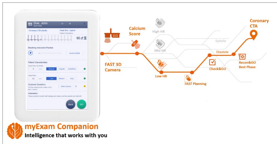
図6 myExam Companionの心臓CT撮影のフロー 患者個々の心拍情報などを基に最適なプロトコルを選択可能
