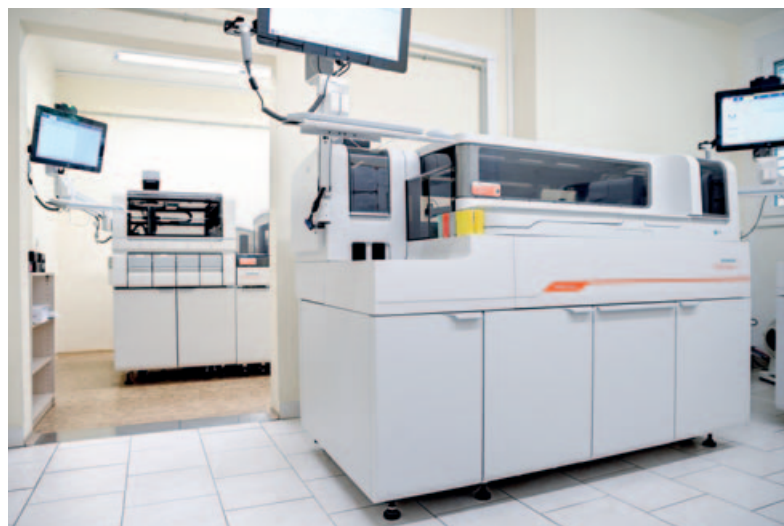
Analytickou linku (v pozadí) tvoří vstupní modul, odzátkovač zkumavek, biochemický a imunochemický analyzátor Atellica Solution. V popředí je samostatný záložní imunochemický analyzátor.
