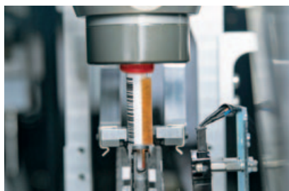
Atellica Decapper zvládne odvíčkovat 300 až 500 zkumavek za hodinu podle zvolené konfigurace
