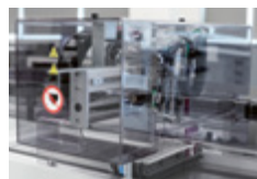
Rack Output-Modul Rack-basierte Probenausgabe mit hohem Durchsatz
