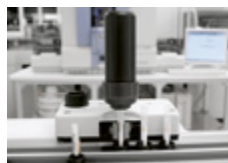
Recapper (für Sekundärröhrchen) Verschließt die vom Aliquoter generierten Sekundärröhrchen mit einem Schraubverschluss
