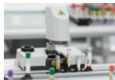
Desealer (für Primärröhrchen) Automatisches Entfernen der Verschlüsse für Wiederholungen, Reflexmessungen und Nachforderungen
