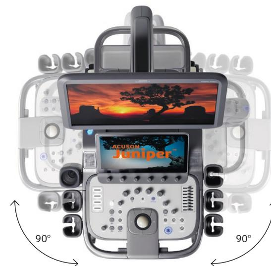
A rotação de 90° para a direita e esquerda permite ao usuário a flexibilidade de escolher a posição dos conectores do transdutor.
