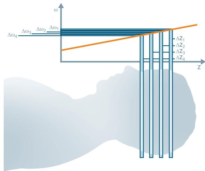
多回波序列使用一系列 90 度和 180 度脉冲，这些脉冲的共振频率不断变化以适应定义的断层位置。这种方法可在测量过程中为我们提供检查特定区域或部位需要的所有断层。
