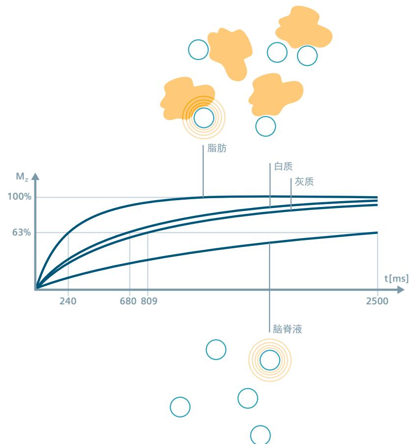
质子的环境中经常包含较大分子（脂质）和高分子（蛋白质）。移动相对较慢的脂肪分子中的氢质子以及与蛋白质结合的质子感受到强局部磁场波动：他们的自旋方向快速变化。这可以解释脂肪之类的组织  $T_1$  相对较短的原因。
