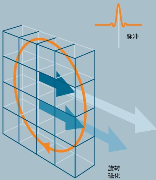
为了显示体内的磁力分布，我们借助电磁脉冲使磁化发生倾斜（左图）。这是磁共振的标志。
