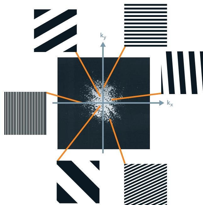
举例演示：通过简单叠加右上图所示的水平和垂直条纹图形，我们可生成复杂的灰度值图形。您会发现，条纹图形的加权叠加将会产生更复杂的图像。
