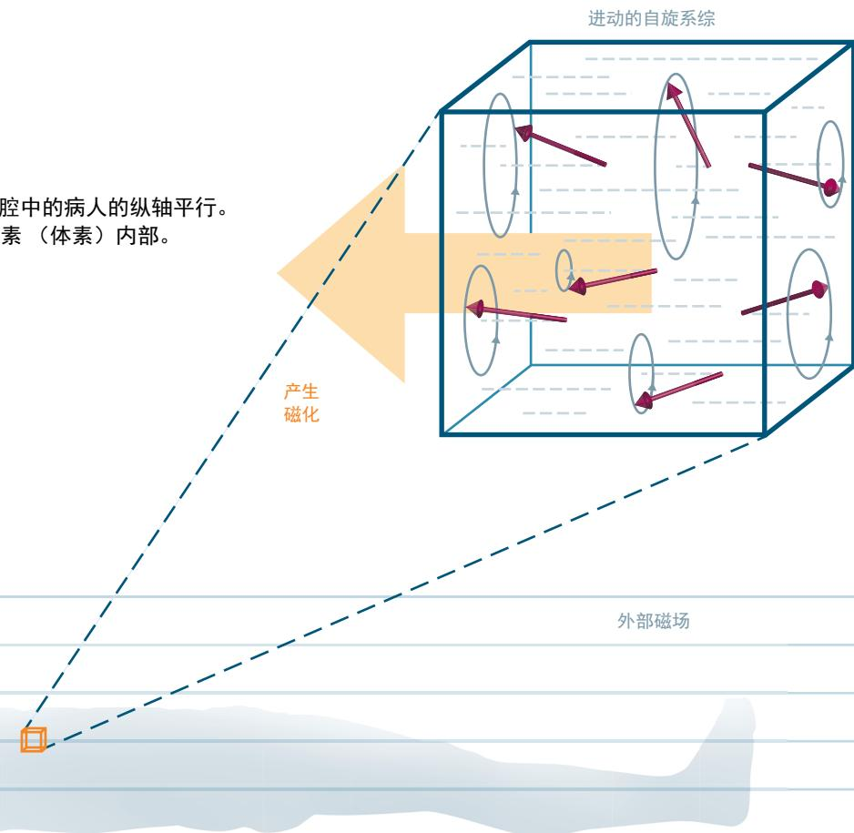
体素内的所有质子自旋共同构成一个大统计数字，称为系综。只要病人位于 MR 扫描系统中，系综的所有磁矩都将绕着外部磁力线进动。它们进动的方向接近均匀分布，但是表面上看小部分系综将倾向于与外部场同向。
