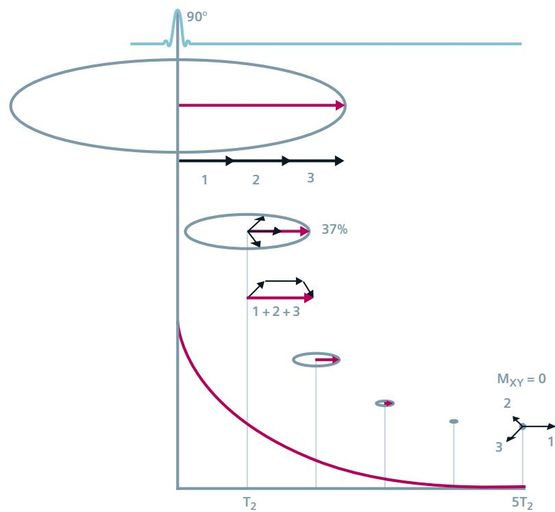
随着横向磁化衰减， MR 信号变弱。这就是我们所谓的横向弛豫。其时间常数称为  $T_2$ 。我们随后将会了解到，这只是磁共振存在的最大时间。实际上， MR 信号（FID）以更快的速度衰减。
