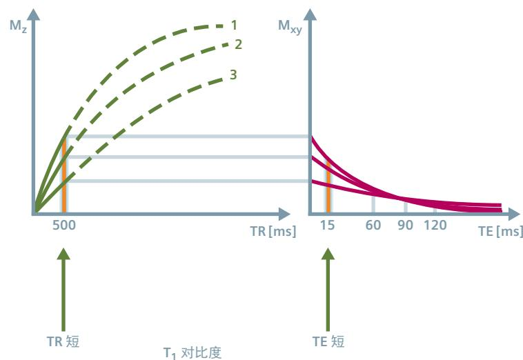
关于  $T_1$  对比度的图像比较: 短 TR (500 ms) ;
