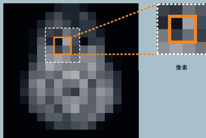
断层图像由大量图片元素（像素）组成。每个像素都有特定的灰度值。图像中的像素越多，意味着分辨率越高。
