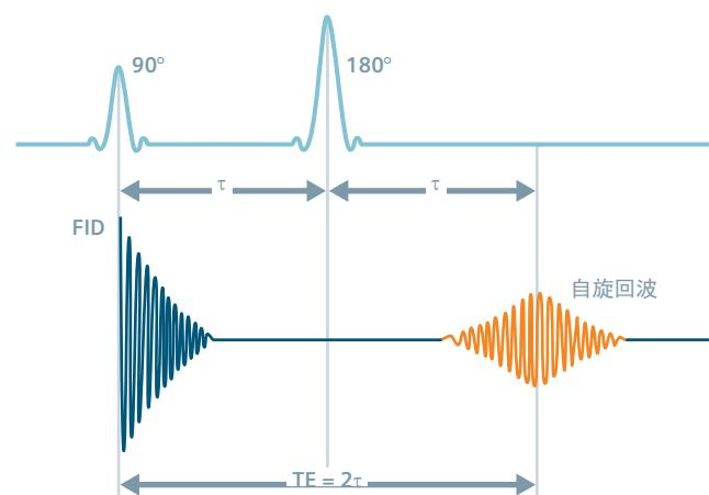
请注意：自旋回波信号按  $T_2^*$  衰减，但是其强度（幅度，最大值）取决于  $T_2$  弛豫曲线。
