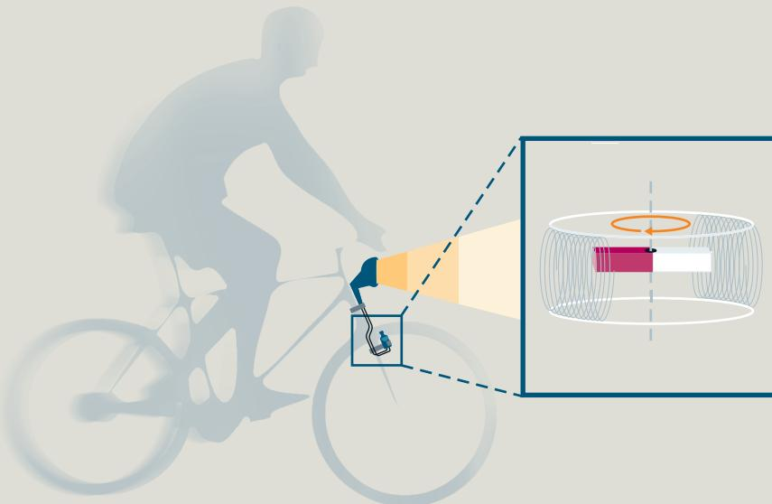
这些磁场变化可在线圈中产生感应电流，用于点亮脚踏车灯。发电机的磁体旋转得越快，感应电压越高，脚踏车发出的光越明亮。
