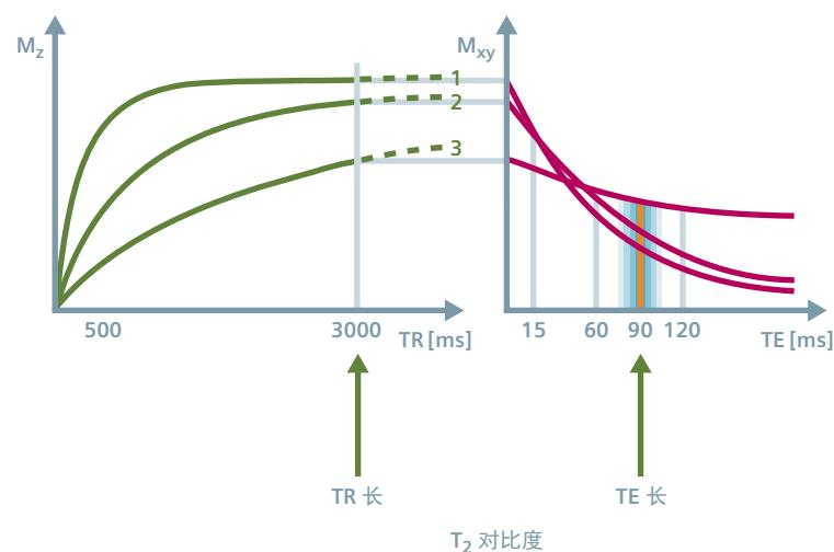
比较右侧图像: TE 增长时, 图像呈现  $T_2$  对比度。
